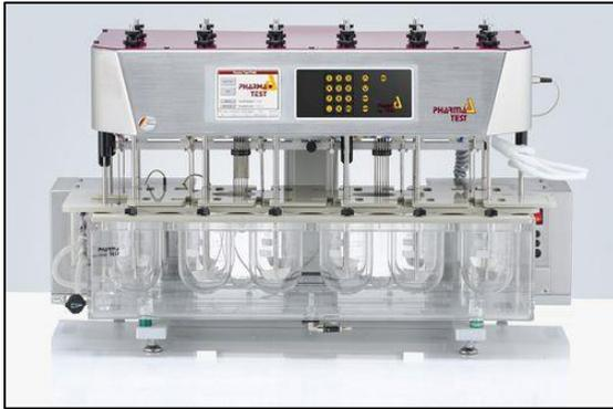
Figure 24 : Appareil Palette /panier tournant<sup>24</sup>
