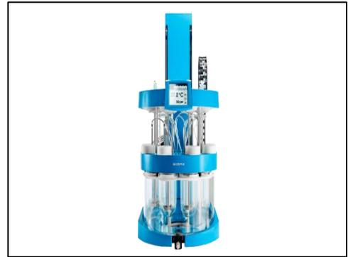
Figure 25 : appareil à flux continu<sup>25</sup>
